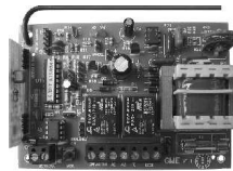
Placa 433 Mhz com chip Motorola Com embreagem, anti-esmagamento, freio eletrônico, soft start (partida suave)
