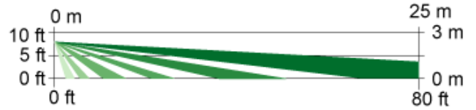
Vista lateral Cobertura de barrera opcional: (OMB77) 25 m x 5 m (80 pies x 16 pies)
